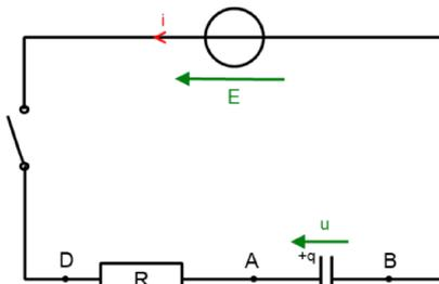
Lorsque l'on ferme l'interrupteur, la tension aux bornes du dipôle RC passe brutalement de 0 à E. On dit que ce dipôle est soumis à un échelon de tension.
